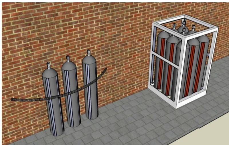
Figur 9: Illustration af sikring mod væltning.
